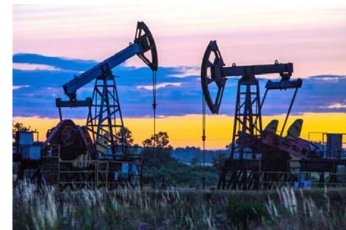
Мал. 230. Насосний спосіб видобутку нафти
